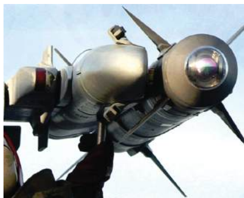
Рисунок 13 – Ракета класса «воздух – воздух» AIM-9X ASRAAM , установленная на крыле самолета (хорошо просматривается объектив ИК-камеры головки самонаведения)
