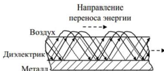
Рисунок 1 – Линия передачи поверхностных волн в виде диэлектрической пластины на металлическом основании с траекторией движения плоских волн
