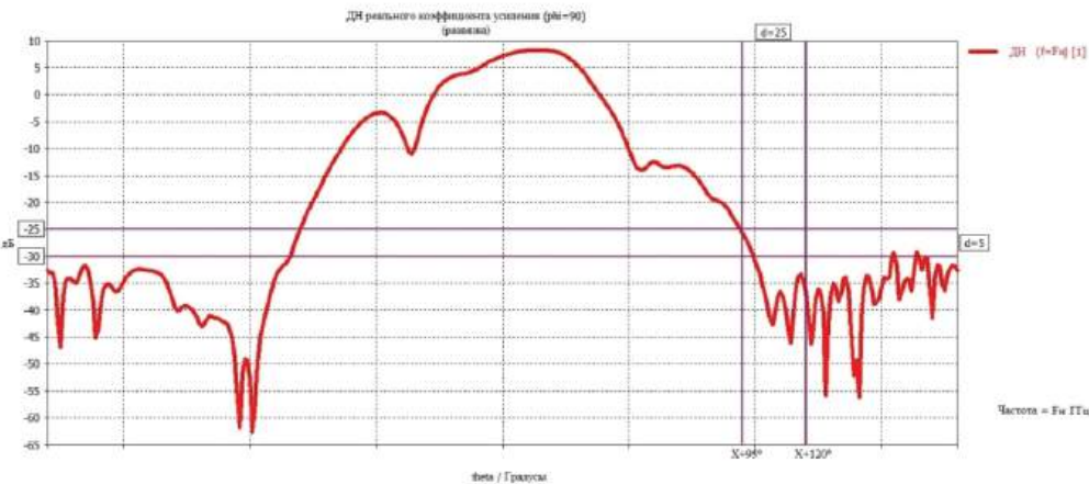
Рисунок 5 – Развязка ДН для антенн сверхширокополосной антенной системы на начальной частоте в заданном секторе по углу места
