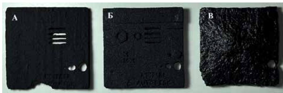
Рисунок 8 – Тестовые изделия, полученные по технологии селективного лазерного спекания. А (70 % мас. антрацита : 30 % мас. новолачная смола), Б – 60 % мас. антрацита : 40 % мас. п новолачная смола, В (50 % мас. антрацита : 50 % мас. новолачная смола)
