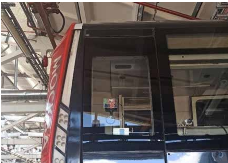
Рисунок 4 – AWR2243Boost, установленная на лобовом стекле поезда метрополитена
