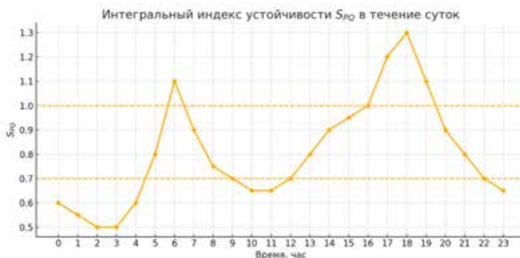
Рисунок 7 – Суточная динамика изменения рассчитанного интегрального индекса устойчивости S_{PQ} для исследуемого производственного комплекса
