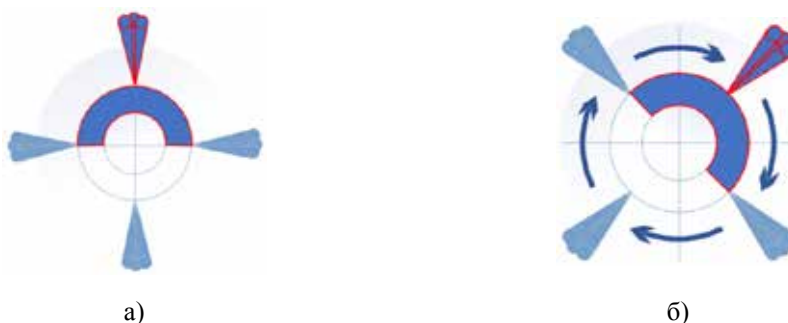
Рисунок 6 – Формирование групп приемных лучей соответствующей частью раскрытия КАФАР (а), поворот групп приемных лучей по азимуту в режиме кругового обзора пространства (б)
