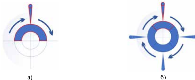
Рисунок 1 – Сектор апертуры КАФАР, задействованный для формирования ДН на передачу в режиме 1 луча (а), сектора апертуры КАФАР, задействованные для формирования ДН на передачу в режиме 4 лучей (б)
