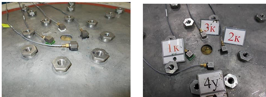
Рисунок 9 – Установка вибродатчиков на стенд (справа показана нумерация)
