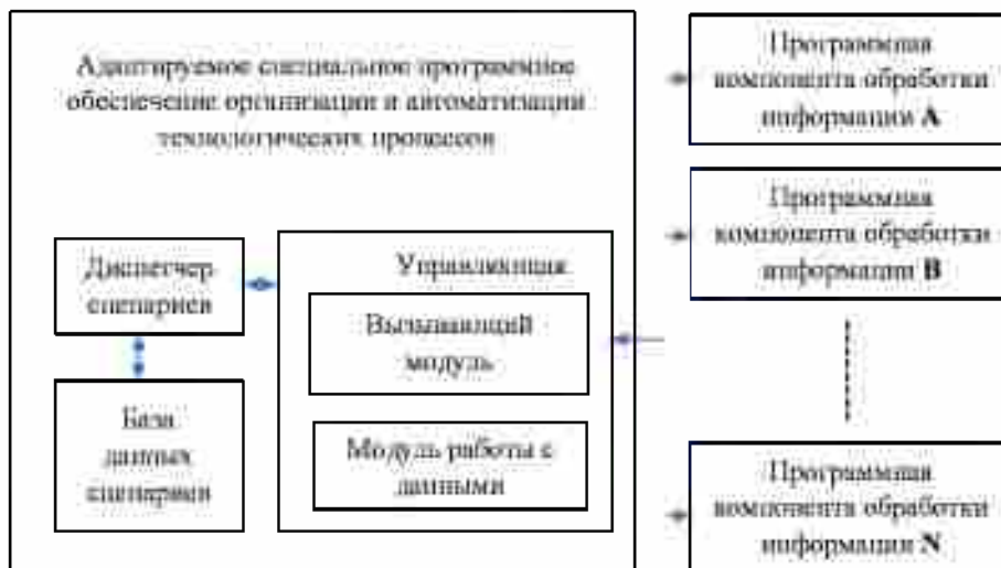
Рисунок 5 – Схема взаимодействия специального программного обеспечения организации и автоматизации технологических процессов с программными компонентами обработки информации
